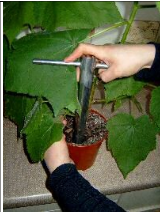
Abb. 2 Setzen des DB in durchwurzelten Topf einer Zimmerlinde
