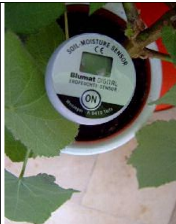
Abb. 6 Anzeige der Saugspannung nach Betätigen der Schalters „ON“
